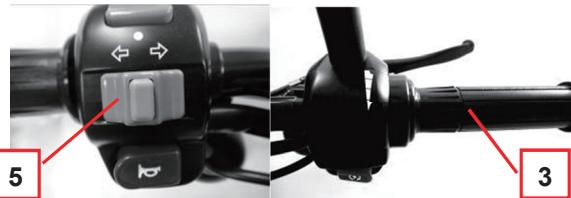
轉向時：將方向燈開關 (5) 推至要轉彎的方向，發出轉彎訊號，看後視鏡確認後方安全，減速至安全速度進行轉彎，轉彎後將方向燈開關復位。
